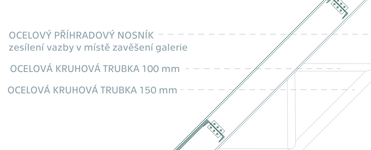
SPOJ ČELNÍ DESKOU – OCELOVÝ NOSNÍK U 300
