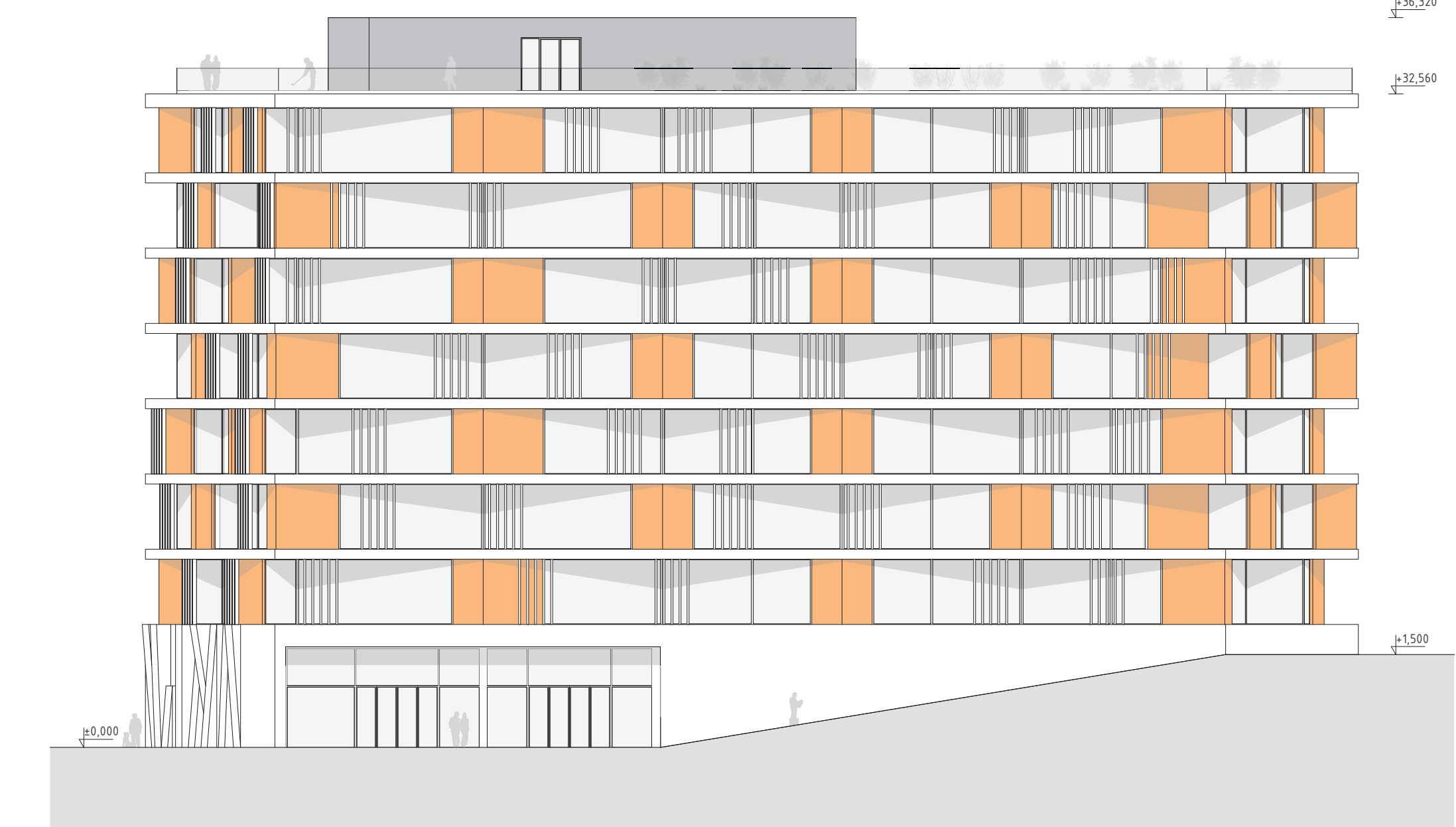
JÍŽNÍ POHLED POHYBLIVÉ STÍNÍCÍ PRVKY A NEPRŮHLÉDNÉ ČÁSTI ZAJIŠŤUJÍ SLUNEČNÍ OCHRANU S DOSTATKEM DENNÍHO OSVĚTLENÍ DO HLUBKY BUDOVY
